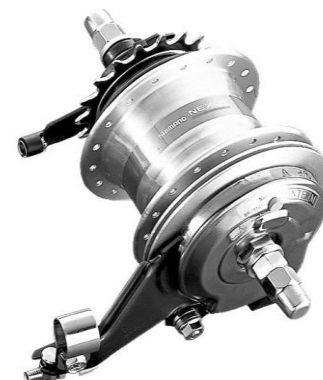
Fig. 1 Photo du moyeu arrière Shimano Nexus Inter 7 avec frein.
